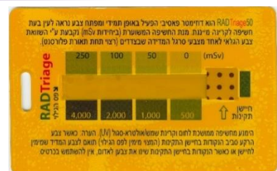
נקודות חיישן התקינות נצבעו לסגול-אדמדם בעקבות חשיפה יתרה לחום
